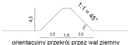
Rysunek 35 Orientacyjny przekrój przez wał ziemny
